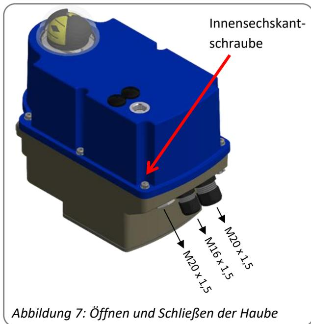
Abbildung 7: Öffnen und Schließen der Haube
