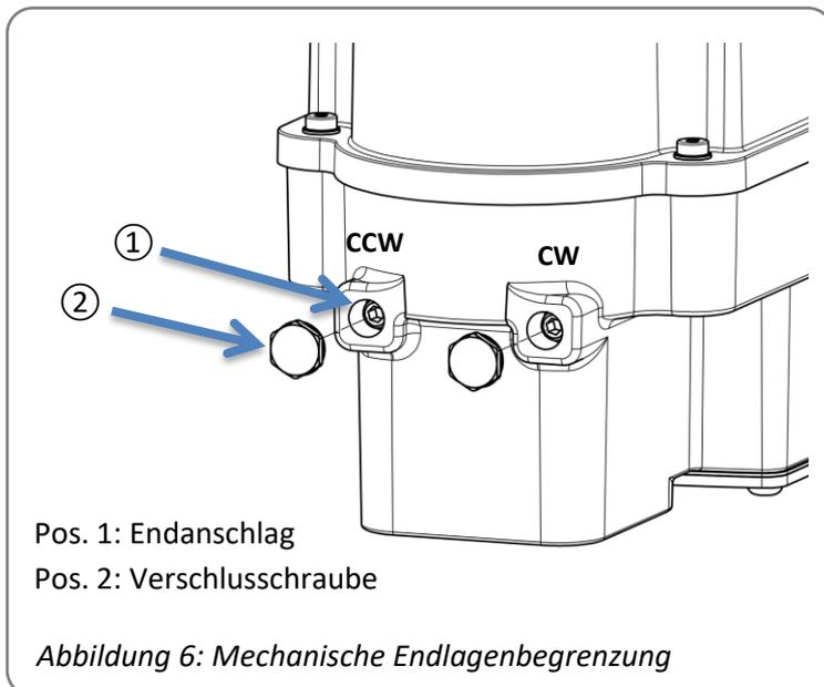
Zur Begrenzung des Antriebsschwenkwinkels stehen zwei einstellbare mechanische Endanschläge zur Verfügung.
