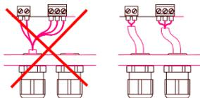
**Alle Netzanschluss- und Steuerleitungen müssen mechanisch durch geeignete Maßnahmen vor den Anschlussklemmen gegen unabsichtliches Lösen gesichert werden. Netzanschluss und Steuerleitungen dürfen nicht zusammen in einer Leitung geführt werden, es sind stets zwei getrennte Leitungen zu verwenden!**
